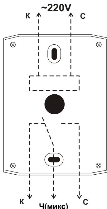
Кабель силового реле (трёхжильный)
